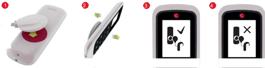
Рис. 4 Сопряжение FineTuner Echo с аудиопроцессором
