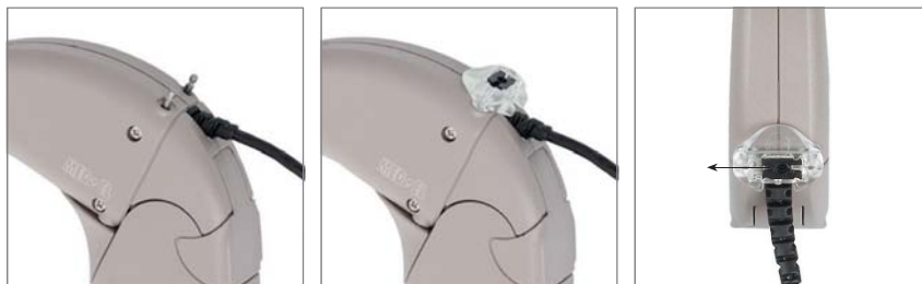
Рис. 8. Предохранительная защелка для блока процессора OPUS 2
