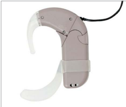
Рис. 10. Спортивный заушный крючок, прикрепленный к аудиопроцессору
