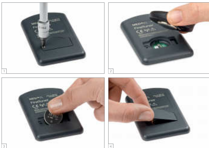
Рис. 16. Замена батареи FineTuner
