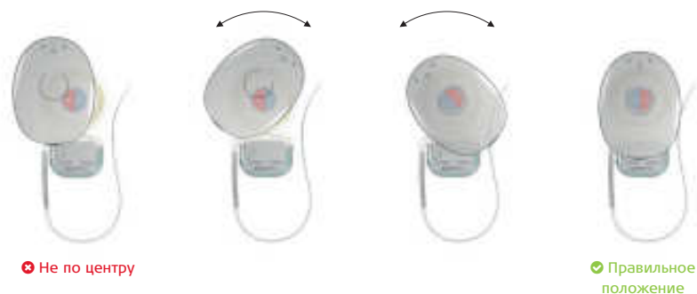
Рис. 10. Совмещение магнитов аудиопроцессора и имплантата. Обратите внимание, что микрофон направлен вверх.
