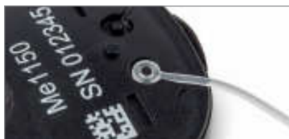
Рис. 13. Фиксация крепления к корпусу аудиопроцессора
