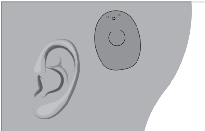
Рис. 3. Аудиопроцессор над областью имплантата. Обратите внимание, что микрофон направлен вверх.
