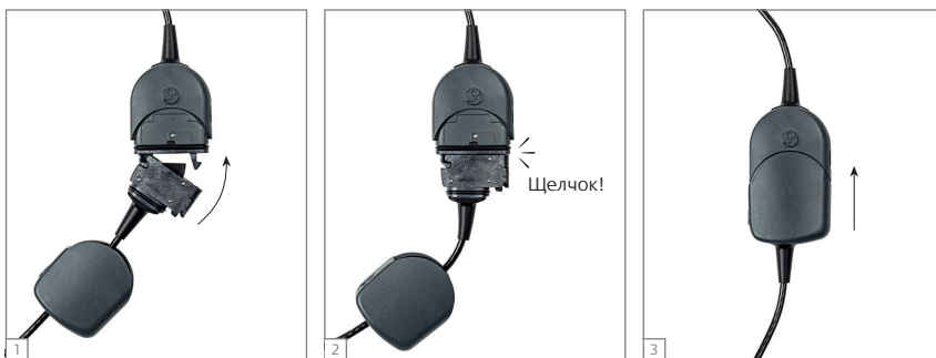
Рис. 11 Подготовка SONNET ActiveWear соединительного кабеля для хранения
