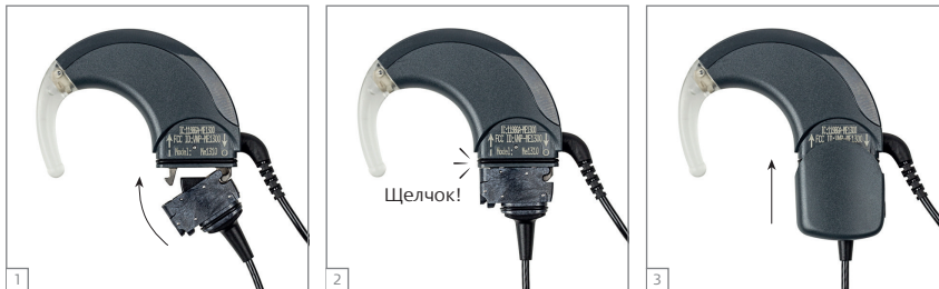
Рис. 5 Подключение разъема SONNET ActiveWear к блоку процессора
