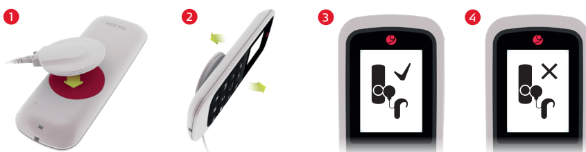
Рис. 4 Сопряжение FineTuner Echo с аудиопроцессором
