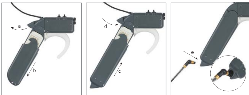
Рис. 8 Подключение FM кабеля к OPUS 1 или ТЕМПО+
