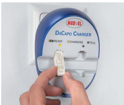
Рис. 9 Установка аккумулятора DaСаро в зарядное устройство DaСаро
