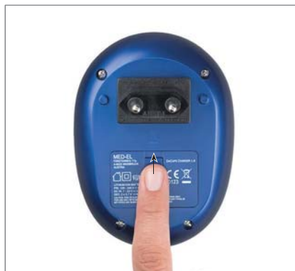
Рис. 13 Сдвиньте защелку, чтобы извлечь адаптер
