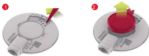
Рис. 16 Извлечение магнита передатчика типа DL
