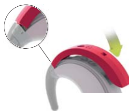
Рис. 35 Установка крышки микрофона
