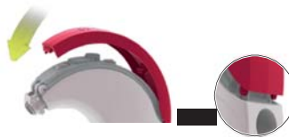
Рис. 37 Установка крышки микрофона
