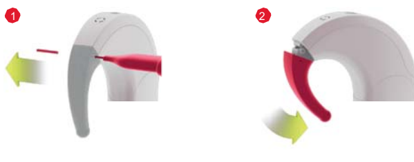
Рис. 29 Отсоединение SONNET заушины
