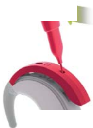
Рис. 34 Снятие крышки микрофона
