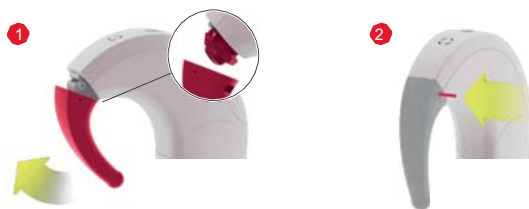
Рис. 29 Отсоединение SONNET заушины
