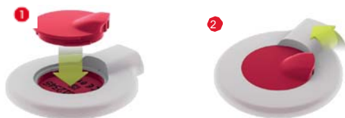
Рис. 22 Установка магнита передатчика типа D
