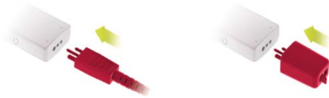
Рис. 38 Подключение кабеля адаптера и FM-приемника системы прямого подключения
