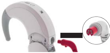
Рис. 25 Подключение SONNET кабеля передатчика к SONNET 2 блоку процессора
