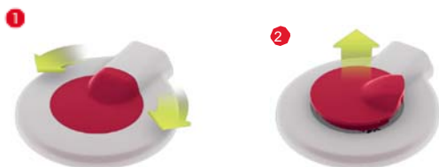
Рис. 21 Извлечение магнита передатчика типа D
