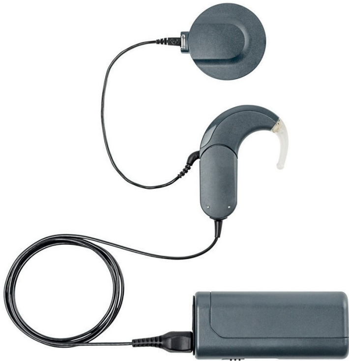
Рис. 10 Миниатюрный блок элементов питания, подключенный к SONNET блоку процессора
