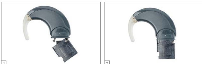
Рис. 8 Подключение SONNET адаптера миниатюрного блока элементов питания к SONNET блоку процессора
