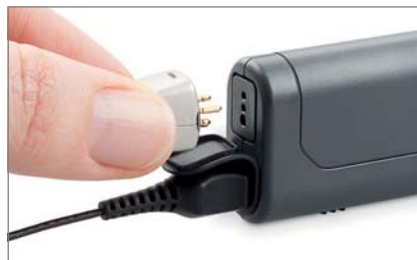
Рис. 13 Подключение FM-систем прямого соединения к гнезду EA миниатюрного блока элементов питания
